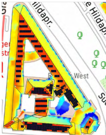
Fig.1: LUBW-Solarkataster Solarpotentialkarte - Umso wärmer die Farbe, desto größer ist das Solarpotential
